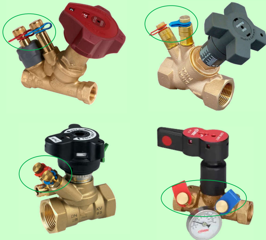
Vanne débitmétriques manuelles avec prises de pression amont / aval
